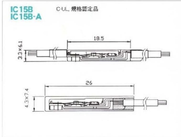
本サーモスタットは大容量のバッテリー保護用として、また、AC/DC兼用大電流通電タイプの安全器です。
