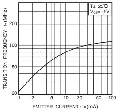
Fig.7 利得帯域幅積-エミッタ電流特性
