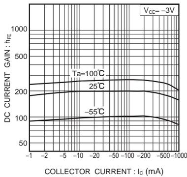
Fig.4 直流電流増幅率
