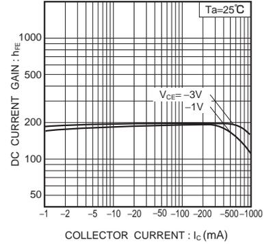
Fig.3 直流電流増幅率
