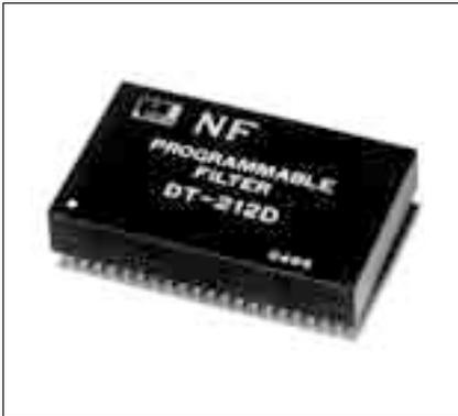
DT-212シリーズは、デジタル信号により周波数を制御できるユニバーサルフィルタです。12dB/octの減衰傾度のローパス及びハイパスフィルタ出力と、6dB/oct・バンド幅の減衰特性のバンドパスフィルタ出力の3出力が同時に得られます。さまざまな特性のフィルタや高次フィルタを構成できるように、通過利得やQは、外付け抵抗により容易に設定することができます。
