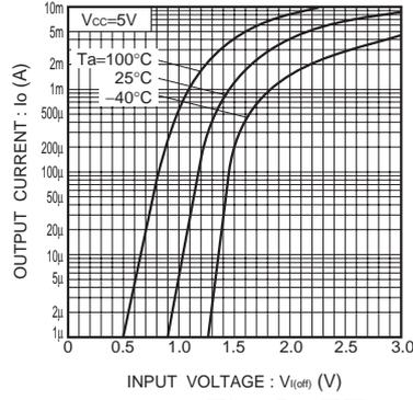
Fig.2 出力電流-入力電圧 (OFF特性)
