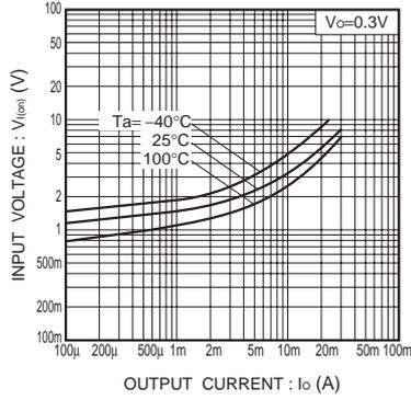
Fig.1 入力電圧-出力電流 (ON特性)
