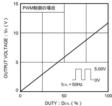
Fig.5 出力電圧制御特性
