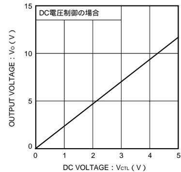
Fig.6 出力電圧制御特性
