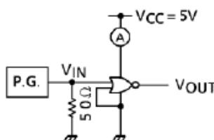
入力波形はAC電気的特性の測定波形と同じ。
